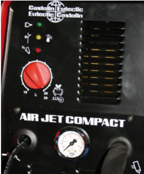
**AIRJET COMPACT** ist ein tragbares Plasmaschneidgerät. Dank der kompakten Bauweise und dem geringen Gewicht ist es der ideale Partner für mobile Einsätze. Für Qualitätsschnitte bis 6 mm in Stahl (bis 10 mm Trennschnitt) wird kein externer Kompressor benötigt. Durch den Einsatz eines externen Kompressors kann die Leistung auf 10 mm Qualitätsschnitt (bis 12 mm Trennschnitt) gesteigert werden.
